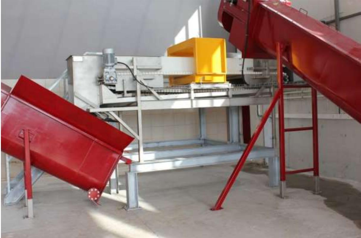
**Funktion:** Die Funktion des Metalldetektors besteht in der Aufspürung und Aussonderung von Metallstücken, die sich im Rohstoff befinden, vor seiner Übergabe in die Produktion.
